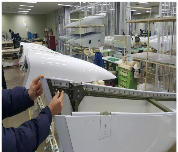
787 FSF PIN PROTRUSION GAUGE INSPECTION
